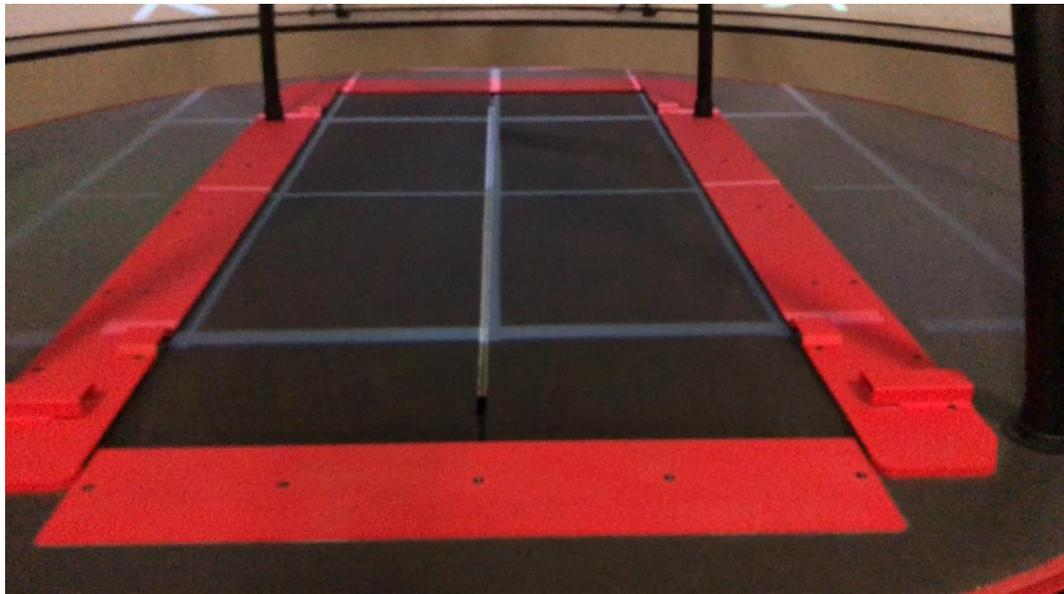
La pedana strumentata con doppio nastro permette una velocità di camminata fino a 5 m/s. Tutta la superficie di ciascun nastro è anche una piattaforma di forza ad alta precisione, in grado di misurare il centro di pressione, i momenti e le forze in tutte le direzioni.
